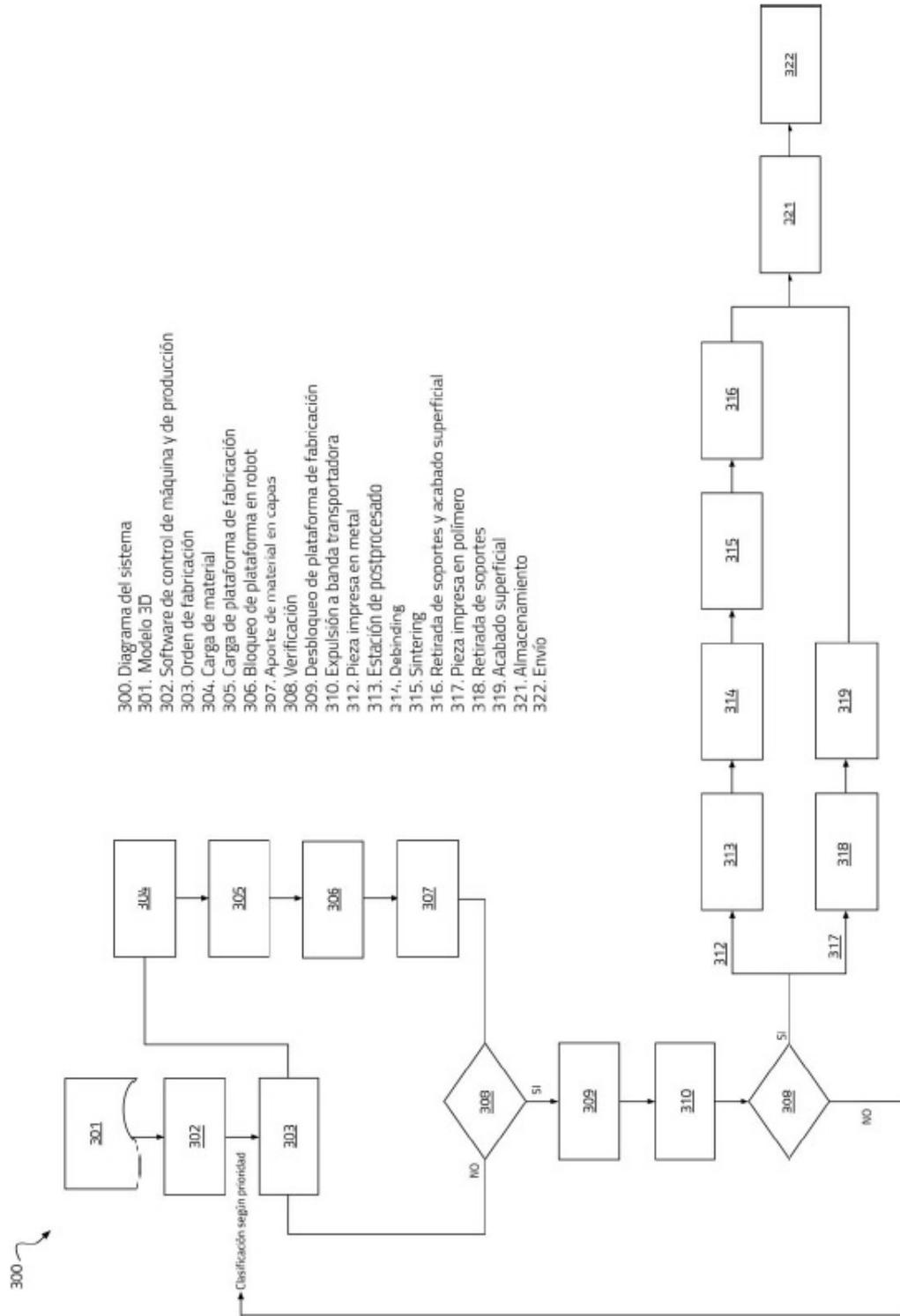
Figura 3A.- Diagrama de flujo de una máquina automatizada de fabricación aditiva
