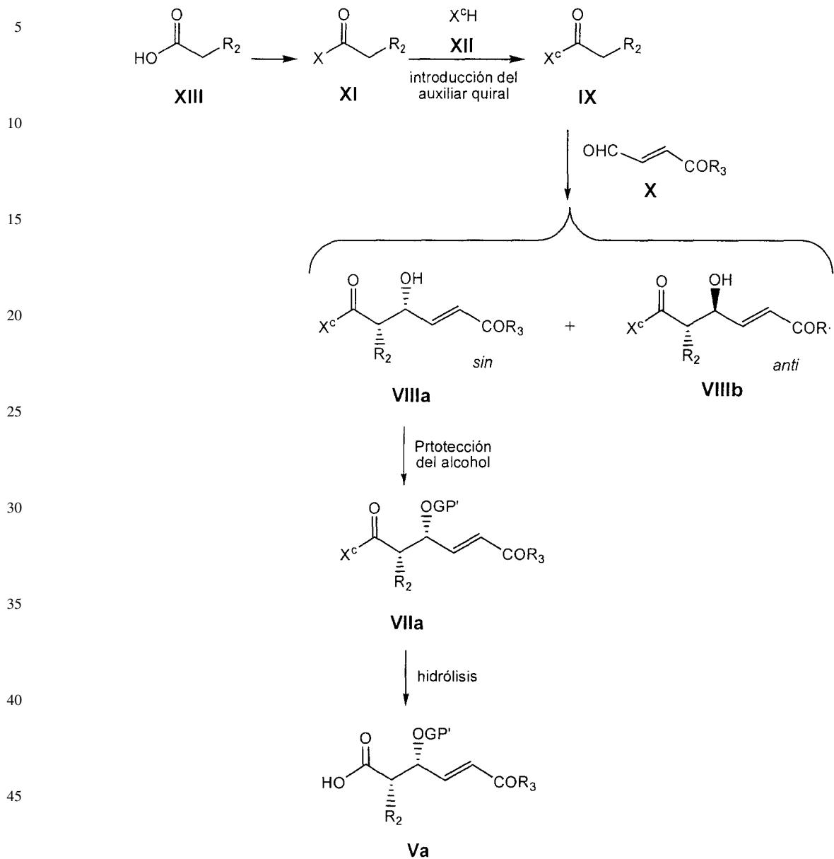
El ácido carboxílico de fórmula XIII se convierte en un derivado acilado de fórmula XI donde X representa halógeno, preferiblemente cloro, mediante reacción con un agente halogenante, por ejemplo cloruro de tionilo, en un disolvente adecuado, como por ejemplo benceno, a una temperatura adecuada, preferiblemente calentando.
