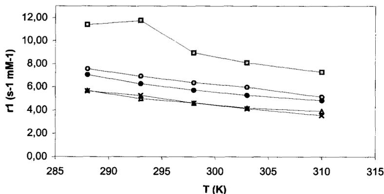
**Figura 2.** Variación de la relajatividad  $r_1$  con la temperatura en disoluciones acuosas 1mM de of  $\times$ ) 1-Gd(III),  $\circ$ ) 2-Gd(III),  $\bullet$ ) 3-Gd(III),  $\square$ ) 4-Gd(III), y  $\Delta$ ) *dtpa*-Gd(III), a un pH  $\sim$  7 y 60 MHz.
