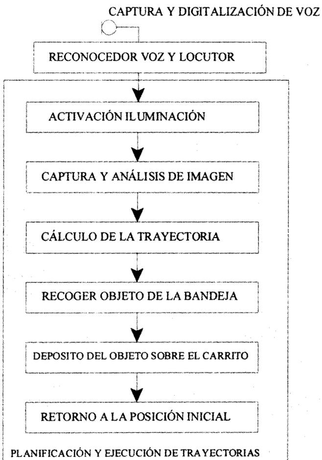
Figura 3. Organigrama mediante el cual un cirujano pide al sistema robótico que recoja de una bandeja cierto instrumento
