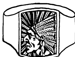
Idem con la cabeza soldada y repasada a buril; lo mismo el fondo (lista para esmaltar)
